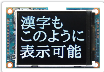
英数字、日本語表示(全角/半角)対応 True Type フォント表示対応
