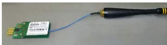
図 4-15 USB Dongle アンテナ取り付け図
