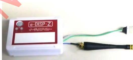
図 4-13 無線モジュール評価機アンテナ取り付け図
