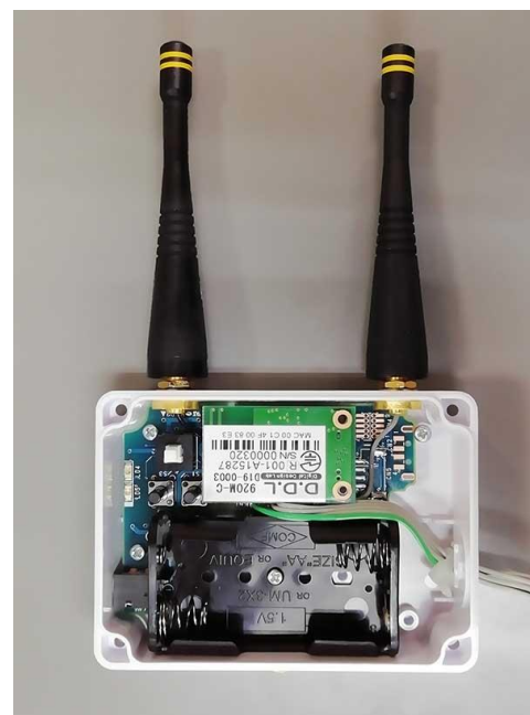
図 3-19 評価機 アンテナ取り付け
